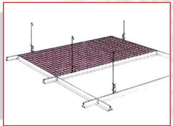
Die meisten Louverlux-Aluminiumraster lassen sich aber auch nahtlos verlegen, d. h., dass die jeweilige Verbindung der Rasterplatten untereinander möglichst nicht erkennbar ist. Hierbei werden die Rasterplatten mit umlaufend halbem Stegüberstand gestoßen und zur Einhaltung der Parallelität miteinander durch Klipsverbindungen gesichert.
